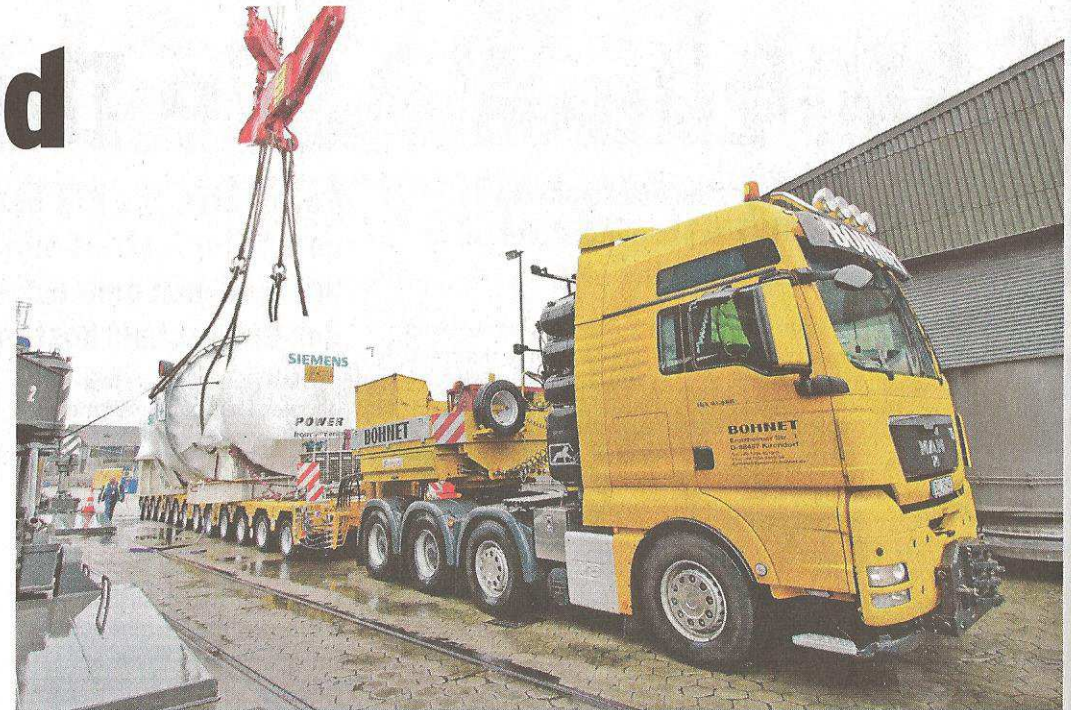
Verladung einer Kraftwerksgasturbine im Hamburger Hafen auf ein Frachtschiff
